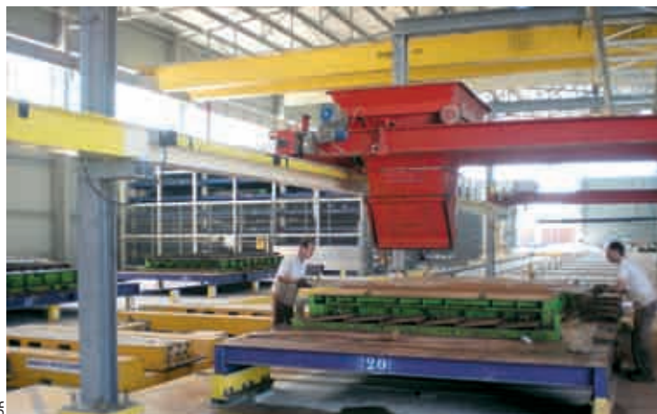
Avec six millions d'euros d'investissement tel le carrousel de fabrication des écrans acoustiques (notre photo) à Malataverne, PBM ambitionne de devenir le leader du mur antibruit à base de béton de bois.
